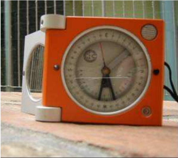
Figura 10 Bussola di clar con clinometro
