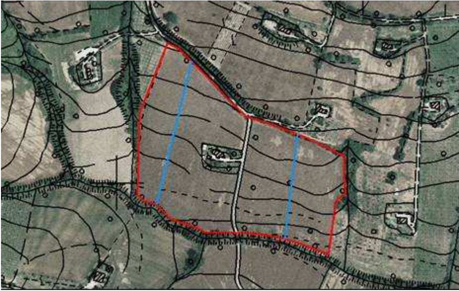
Figura 7 Calcolo della lunghezza del versante geografica piana su ortofotocarta e carta tecnica 1:10.000 come media di profili (in blu) rappresentativi dell'appezzamento candidato al bando in oggetto (in rosso). Per ottenere poi la lunghezza topografica del versante (lunghezza reale – input del modello) correggere per la pendenza media calcolata sugli stessi profili rappresentativi.
